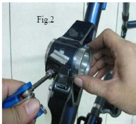
ステップ 4) BBアダプターとキックスタンドを取り付けます(Fig2) (6mm六角レンチ)。その後SD165を取り付け、ボックススパナで締め付けます(Fig4)。トルクは140-160Nmです。
